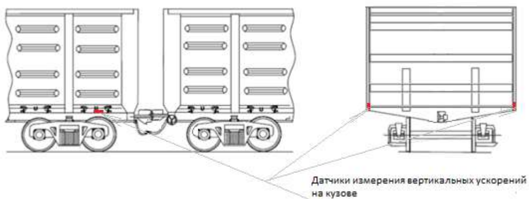
Рисунок 3.3 – Схема размещения датчиков для записи ускорений на кузове вагона
