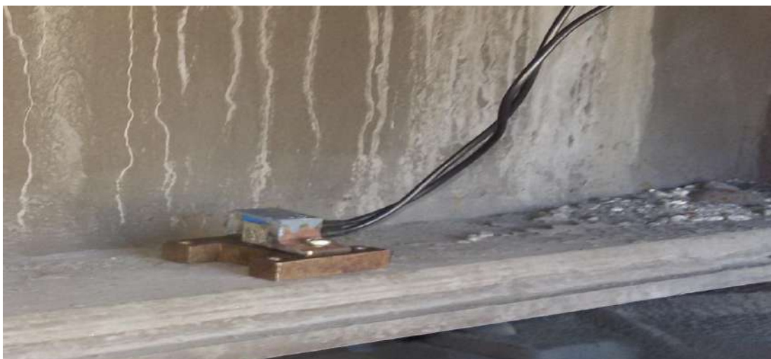
Рисунок 3.5 – Пример установки датчиков для измерения ускорений на кузове (правая сторона).
