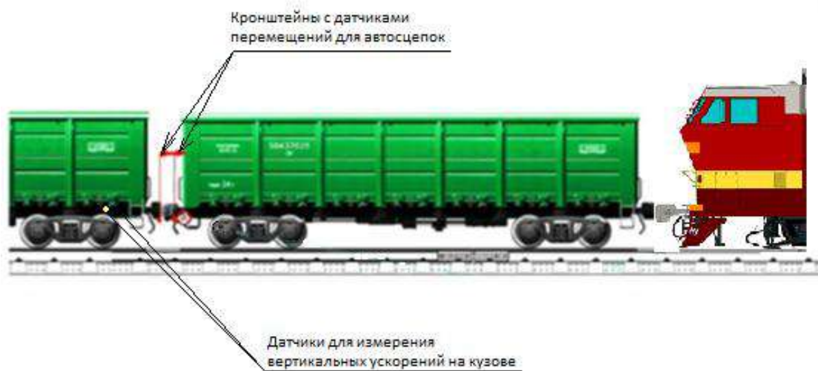
Рисунок 3.1 – Схема размещения датчиков на опытном вагоне
