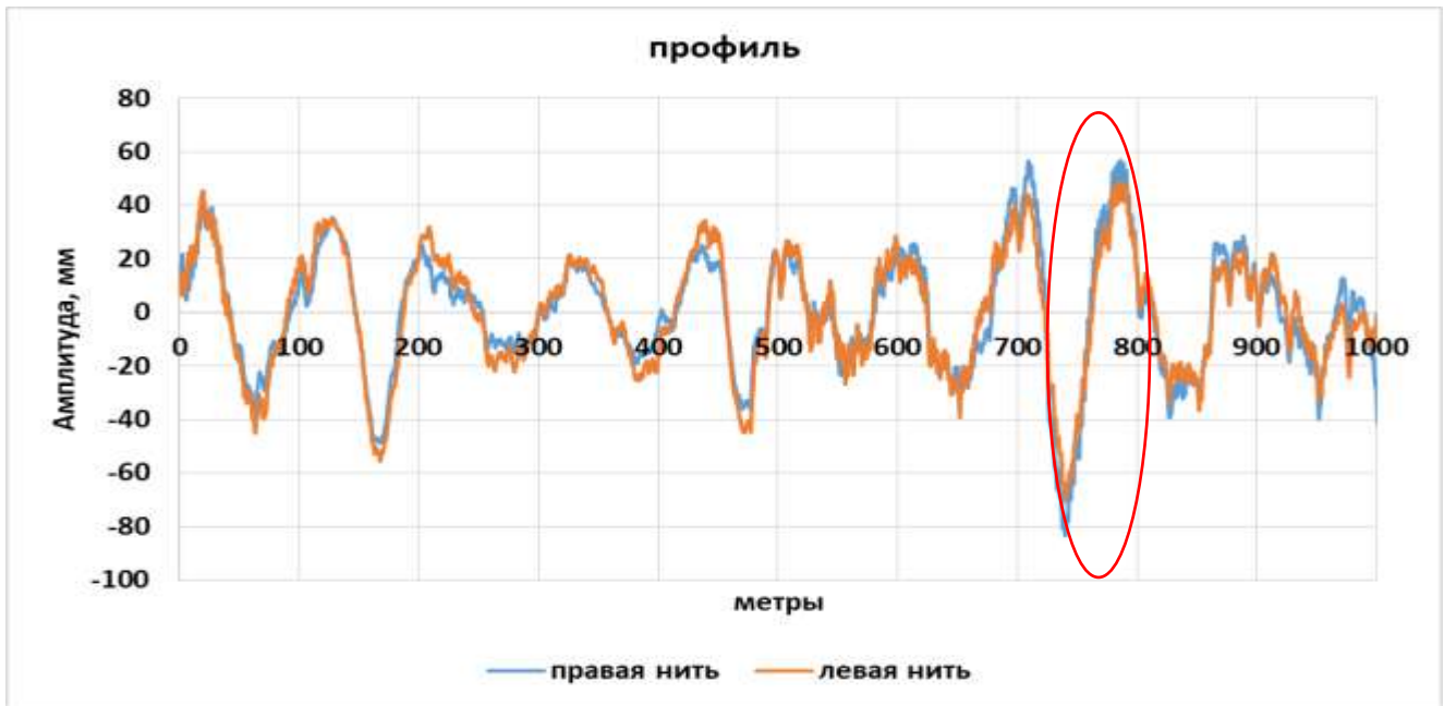
Рисунок 2.27 – Неровности продольного профиля на месте схода подвижного состава 100 км, 1 путь, Дальневосточная железная дорога.
